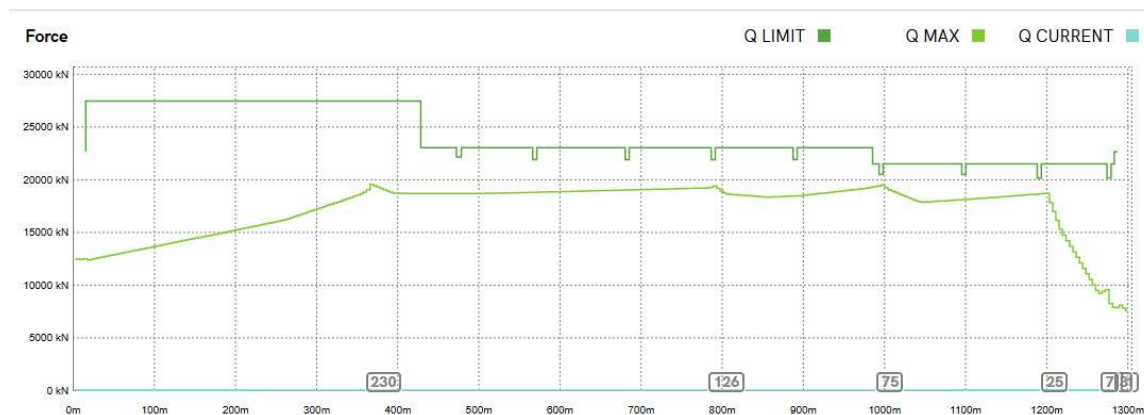
Afbeelding 11.33 Verloop van de persdruk bij het referentieproject Ecluse II, de persdrukken zijn netjes binnen de vooropgebleven waardes gebleven
