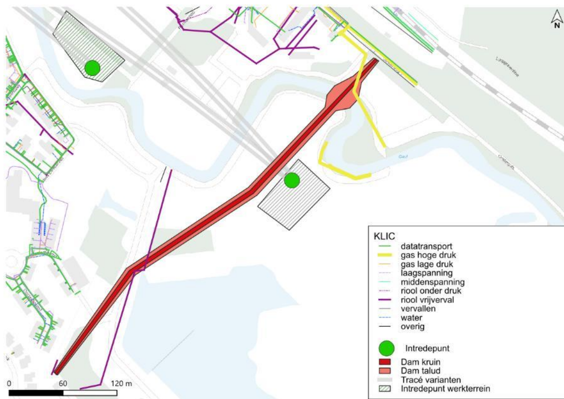
Afbeelding 5.2 Kruisingen bestaande kabels en leidingen met strekdam
